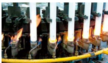
Ein Erdgas-Sauerstoff-Brenner für LightTech.
