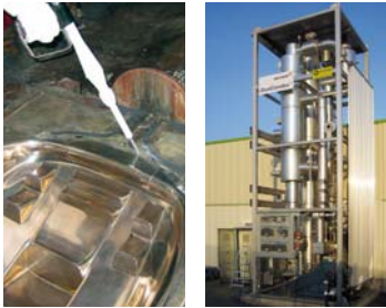
Bild links: Reinigen mit Trockeneispellets löst mehr und mehr herkömmliche Strahlverfahren ab. Bild rechts: Das DuoCondex-Verfahren ermöglicht die Abluftreinigung mit Stickstoff.
